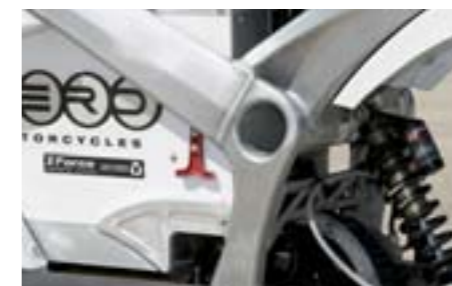
En el costado izquierdo encontramos un desconector de corriente de seguridad.
