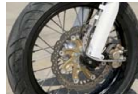
El freno delantero resulta algo justo en potencia; las llantas son de radios y de 16" en ambos trenes.
